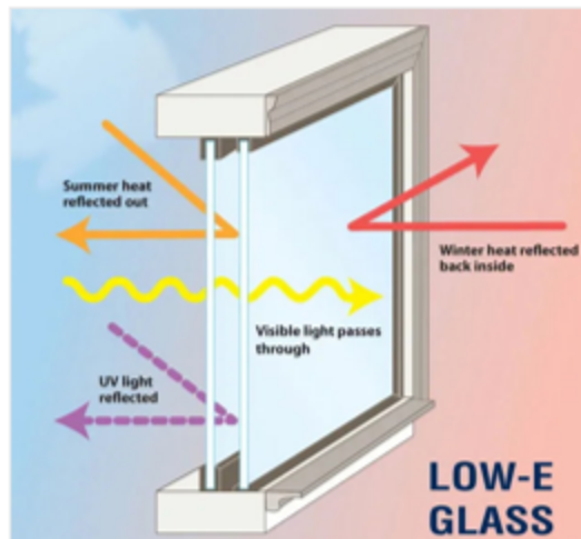
Low-E 玻璃隔热原理
